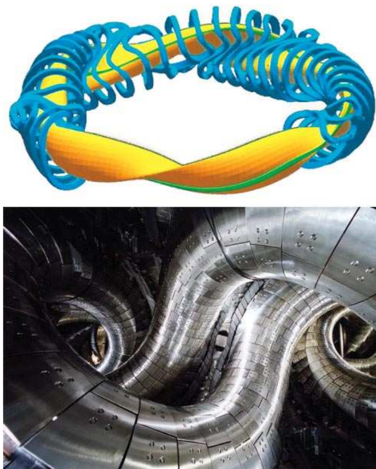
Rysunek 34: Schemat uzwojenia STELLARATORA i kształtu plazmy (górna część rysunku) a także zdjęcie gotowego urządzenia (dolna część rysunku)
