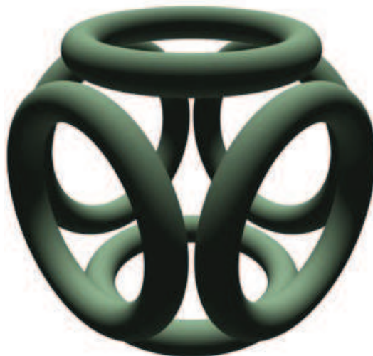
Rysunek 39: Przykład układu cewek wytwarzających pole magnetyczne w reaktorze typu POLYWELL [10].
